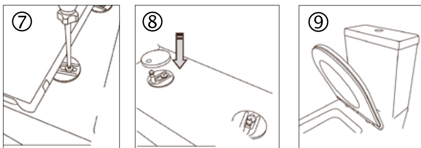
Fig. 7: Når setet er justert i riktig posisjon strammes skruene helt
